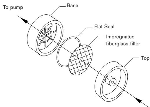
Fig. 44: Isocyanate sampler
