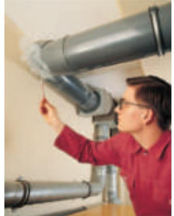
Fig. 37: Dräger air flow tester
