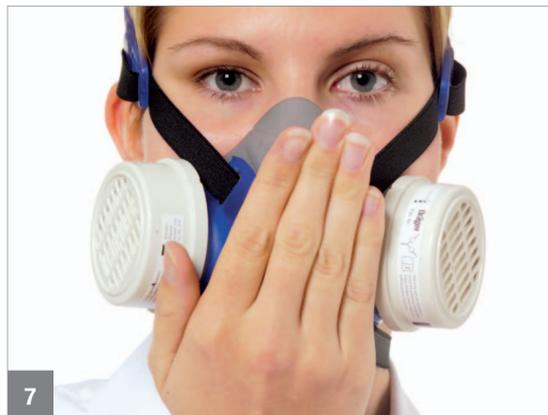
7 **Überdruckprüfung:** Ausatemventil dichthalten und einmal kräftig ausatmen. In der Maske baut sich kurzzeitig ein leichter Überdruck auf. Falls Luft über den Dichtrahmen abströmt, Maske zurechtrücken und Bebänderung nachziehen oder andere Größe verwenden. Prüfung wiederholen bis Maske dicht sitzt.
