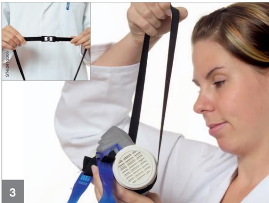
3 Bebänderung über den Kopf ziehen. Bei Dräger X-plore® 3500 Verschlussklappen der Bebänderung schließen (s. kl. Abb.)
