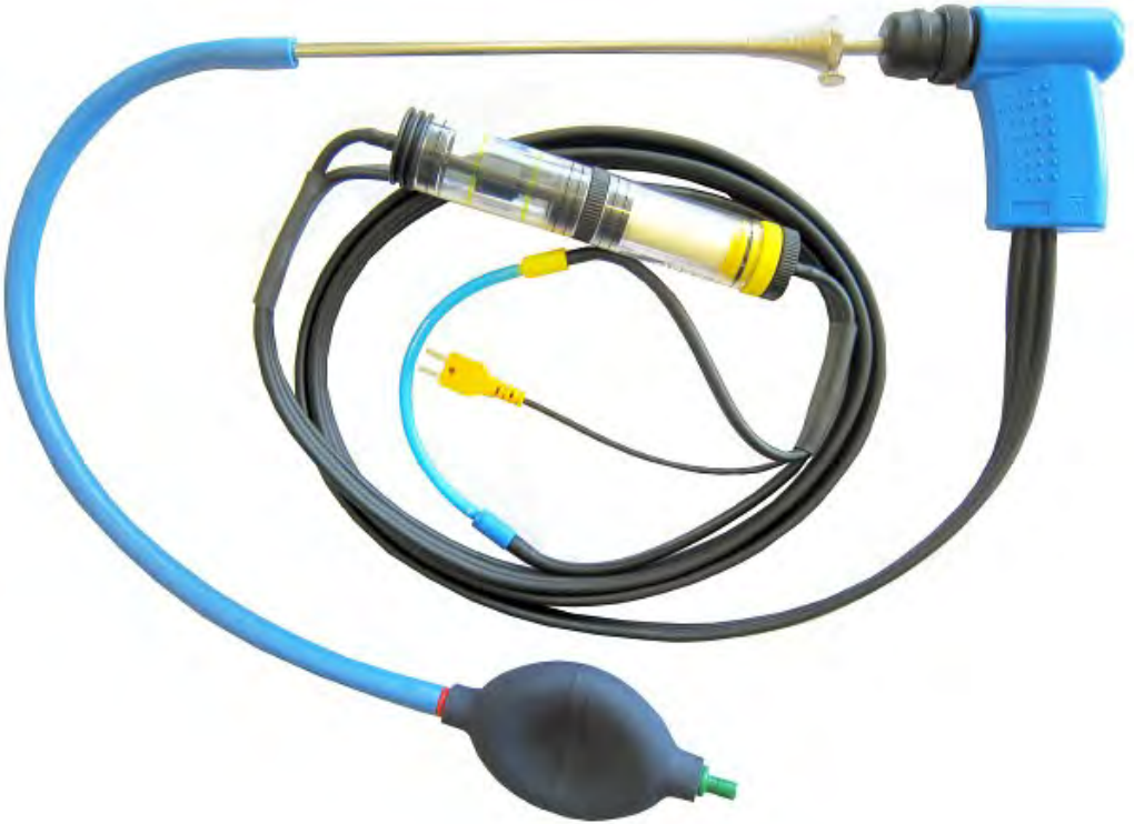
Bild 4: Aufbau der Dichtheitsprüfung mit den Sondendichtheitsprüfung-Set (Art.-Nr.: 511017)
