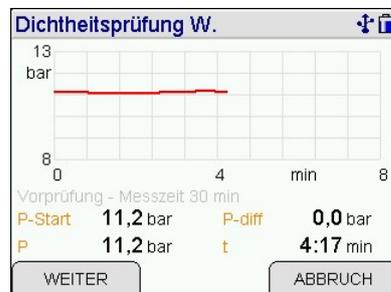
Am Ende der Messung oder nach manueller Beendigung wird zur Ergebnisanzeige gewechselt und das Dokumentationsmenü kann aufgerufen werden.
