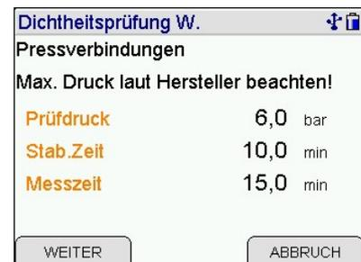
Die externe Pumpe über ein Ventil mit der Leitung verbinden und den Druck erhöhen. Ist der Prüfdruck erreicht, wird mit (WEITER) die Stabilisierungsphase gestartet.
