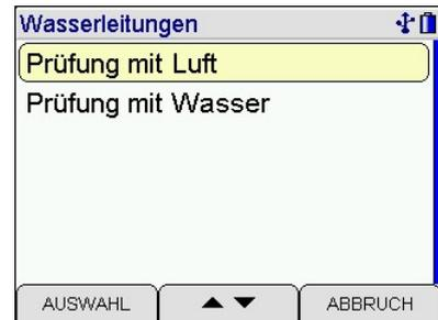
Die Prüfung mit Wasser sollte aus hygienischen Gründen erst unmittelbar vor der Inbetriebnahme der Trinkwasserinstallation durchgeführt werden.
