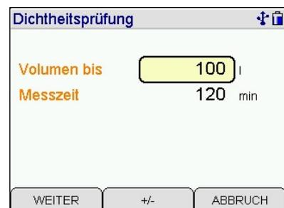
Die Messzeit wird in Abhängigkeit vom Volumen automatisch berechnet.
