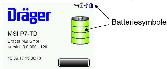
Die Batteriesymbole zeigen den Ladezustand der Batterie an, hier volle Kapazität. Der Balken zeigt den Fortschritt der Überprüfungs- und Stabilisierungsphase an. Außerdem werden die Softwareversion des Gerätes, ein angewählter Prüfer, Datum und Uhrzeit angezeigt.
