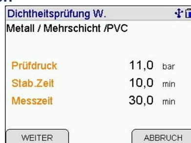
Drucksensor an die zu prüfende Leitung anschließen und Messung starten.
