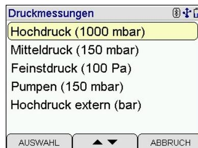
Differenzdruckmessungen mit dem integrierten Drucksensor (150 hPa (mbar)) werden in der Funktion „Mitteldruck“ durchgeführt.
