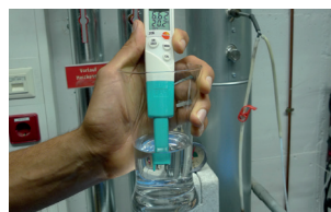
Ideale per il monitoraggio dell'acqua negli impianti di riscaldamento secondo la norma VDI 2035.
