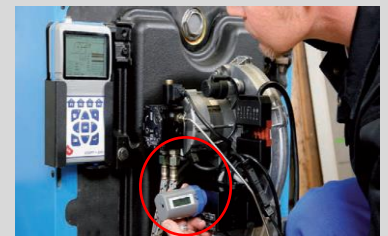
Das Großdisplay des ecom-J2KNpro spiegelt die vom ecom-AK übermittelten Werte wieder.
