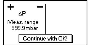
Nach dem Einschalten des Gerätes werden Bezeichnung und Messbereich des Drucksensors eingeblendet. Durch Betätigung der <OK>-Taste kann zur Messwertanzeige geschaltet werden.
